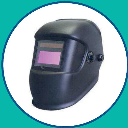
**Máscara de solda modelo automático** que se ajusta à intensidade luminosa da atividade, com moldura externa confeccionada em plástico nylon poliamida, filtro e luz composto de lâminas de vidro sobrepostas, elementos polarizadores de cristal líquido e filtro de luz que possuem marcação indelével, indestrutível, indicando a marca do fabricante, norma técnica de referência, tonalidade do filtro e símbolo de resistência a impactos (norma ANSI = “H”).
