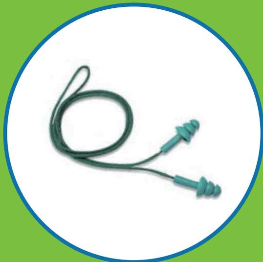
**Protetor auditivo** de inserção tipo pré-moldado reutilizável, confeccionado em borracha de silicone inerte, neutro e antialérgico, com dois plugues no formato de pinos com três discos de dimensões variáveis entre 8 mm e 11 mm favorecendo melhor ajuste. Os plugues são ligados por um cordão em algodão ou material sintético.
