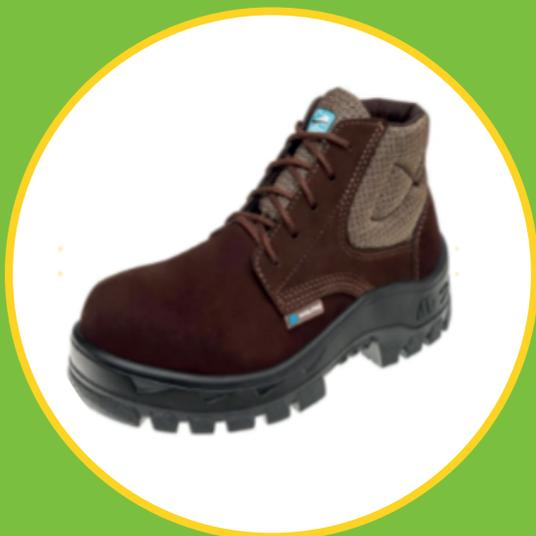
**Calçado de segurança** isolante elétrico tipo botina confeccionada em vaqueta, com biqueira de composite, sem componentes metálicos, fechamento com atacadores para amarrar, dorso acolchoado em espuma, com palmilha de montagem em aramida antiperfurante fixada pelo sistema strobel, palmilha interna removível, solado em poliuretano antiderrapante bidensidade injetado diretamente ao cabedal e sistema de absorção de impacto na região do calcanhar ou barra anti-torção, para uso eletricista.
