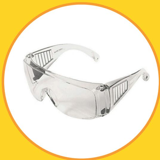
**Óculos de segurança** para sobrepor constituído de armação e visor confeccionados em uma única peça de policarbonato, protetor lateral e borda superior com meia-proteção na parte frontal e bordas, injetados do mesmo material e hastes tipo espátula fixadas à armação através de pinos plásticos. As hastes são compostas de duas peças sendo uma peça confeccionada do mesmo material da armação e dotada de proteção lateral com sistema de ventilação indireta composto de três fendas.
