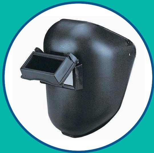
**Máscara de solda modelo basculável** para cima da cabeça do usuário e permite o trabalho com as duas mãos livres, composta de Celeron resistente ao calor, com carneira de plástico, com regulagem de tamanho através de ajuste simples ou através de catraca, com lente protetora incolor e filtros de luz que possuem marcação indelével, indestrutível, indicando a marca do fabricante, norma técnica de referência, tonalidade do filtro e símbolo de resistência a impactos (norma ANSI = “H”).
