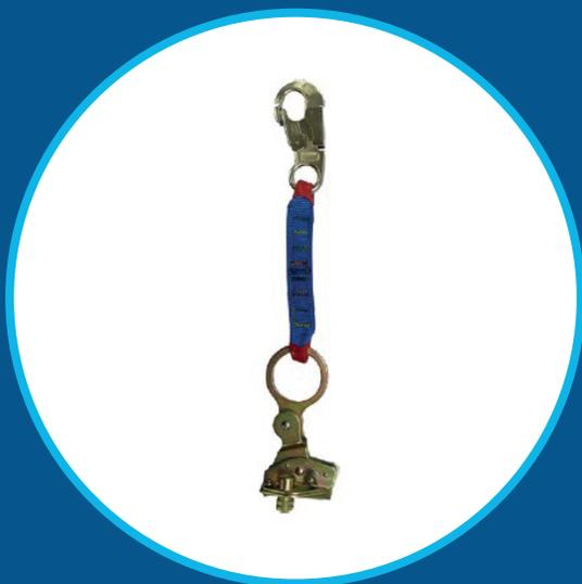
**Trava-queda** para corda de 12 mm, fechamento dupla trava, conector com abertura de 25 mm, conector classe T trava dupla, extensor medindo 30 cm, largura do extensor de 25 mm, alavanca para posicionar equipamento na corda.
