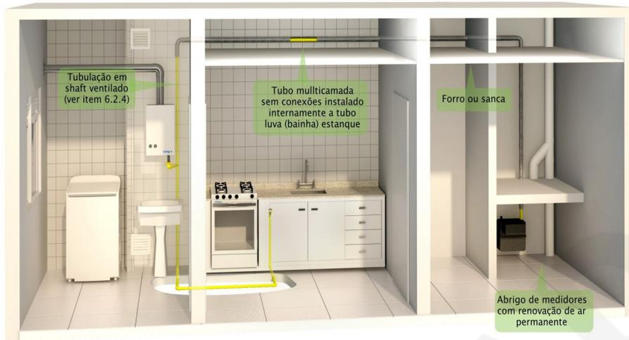
Figura 9-6: Instalação de tubulação multicamada por forro.
