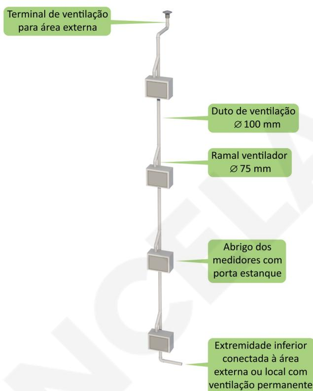
Figura 7-B: Duto de ventilação dos abrigos de medidores em hall serviço (área comum).
