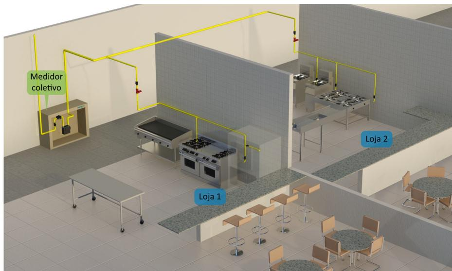
Figura 4-A: Tipologia de medição coletiva no uso comercial.
