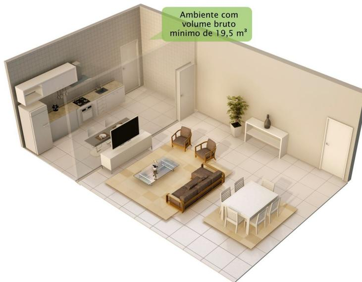
Figura 2-2: Cozinha sem requisitos para ventilação.
