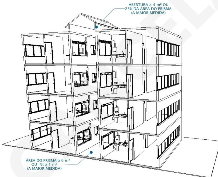
Figura 8-1: Prisma de ventilação usado para descargas de gases.
