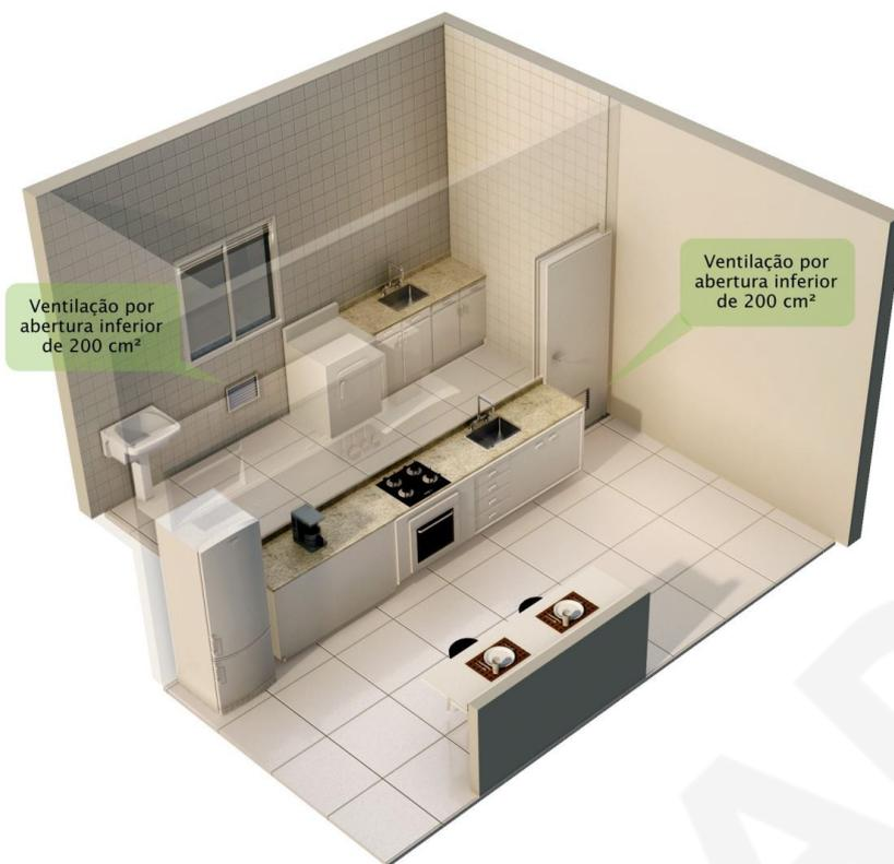
Figura 6-2: Ventilação de ambiente para uso exclusivo de cocção (ventilação inferior).
