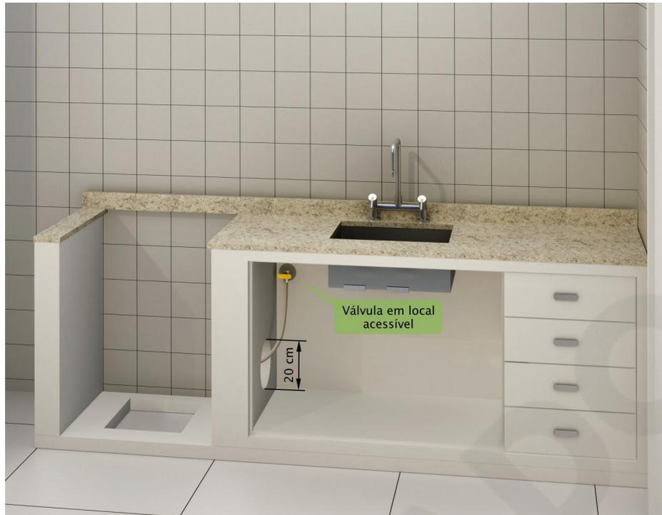
Figura 9-C: Instalação do fogão e válvula de boqueio – fogão de embutir.
