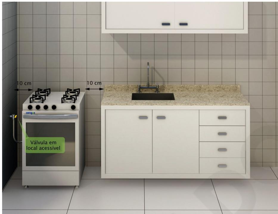
Figuras 7-C: Válvula de boqueio em fogão apoiado no piso – lateral (em área livre).
