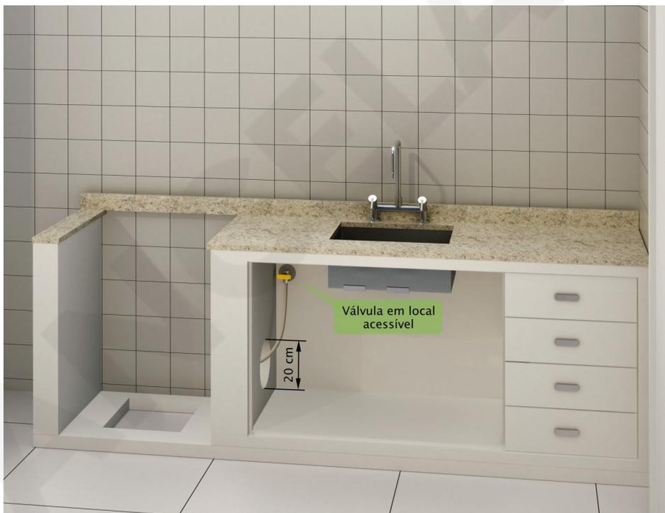
Figura 14-B: Instalação do fogão e válvula de boqueio – fogão de embutir.
