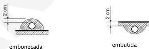
Figura 7-6: Instalação de tubulação embonecada ou embutida
