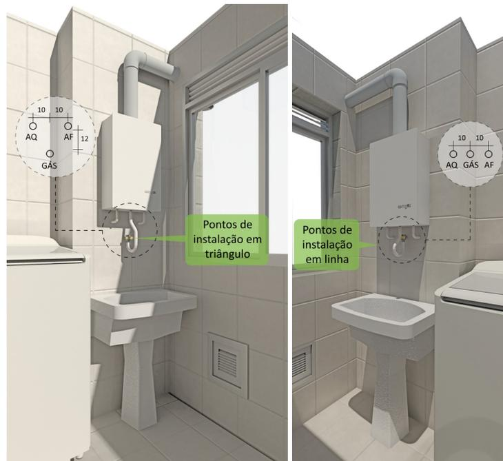
Figura 11-C: Formas de instalação dos aquecedores de passagem
