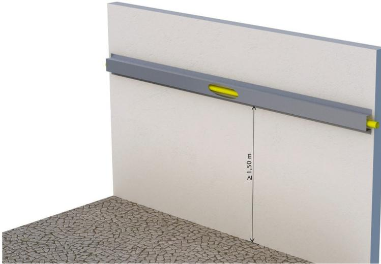
Figura 26-6: Proteção mecânica horizontal
