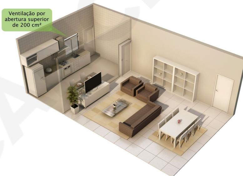
Figura 5-2: Ventilação de ambiente para uso exclusivo de cocção (ventilação superior).
