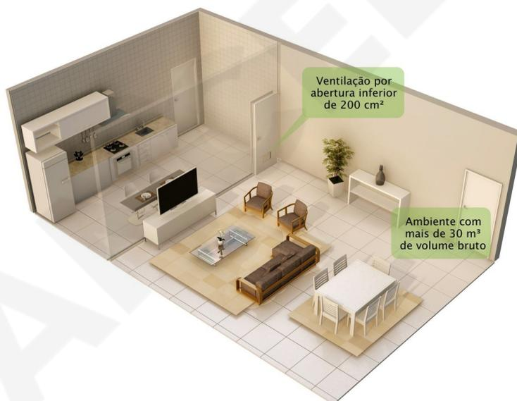
Figura 7-2: Ventilação de ambiente para uso exclusivo de cocção (ventilação inferior – alternativa).
