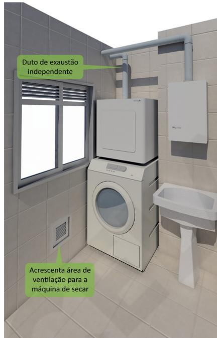
Figura 16-B: Exemplo de instalação de secadora a gás.
