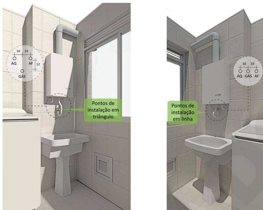
Figura 15-B: Formas de instalação dos aquecedores de passagem.
