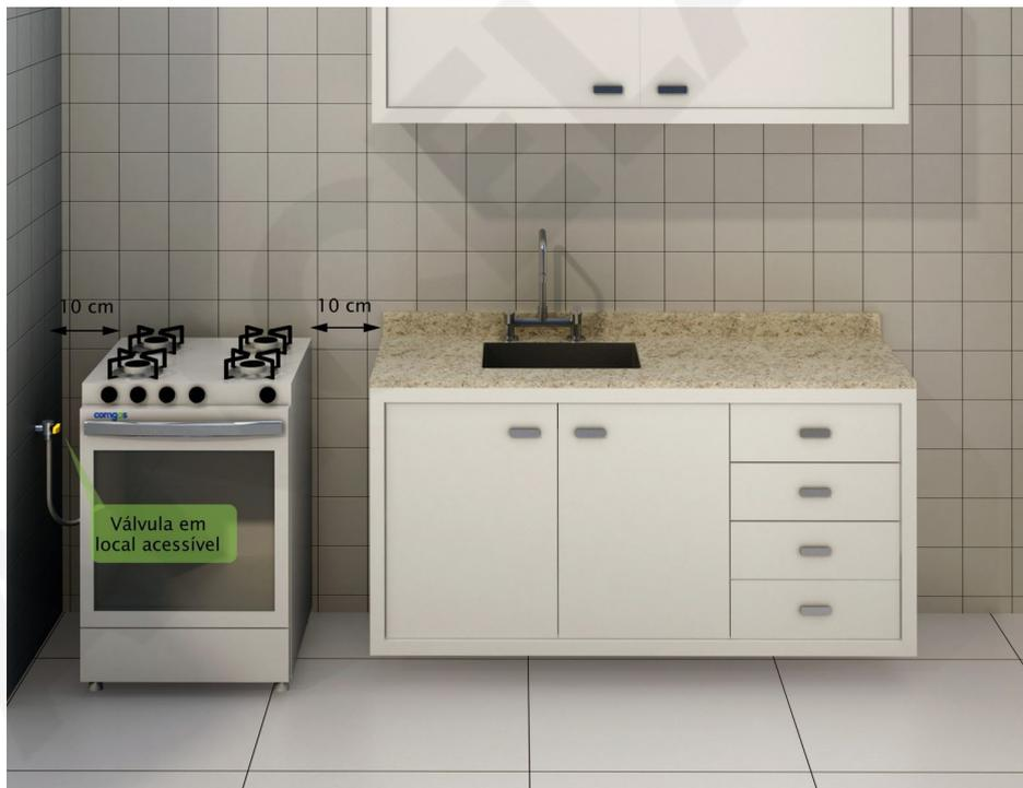
Figuras 12-B: Válvula de boqueio em fogão apoiado no piso – lateral (em área livre).
