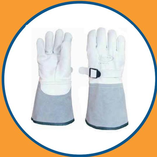
**Luva de segurança** confeccionada em couro de vaqueta para cobertura de luva isolante de borracha, confeccionada em vaqueta inteira ou apenas na palma, reforço externo entre os dedos, punho tamanho 15 cm pode ser em lona com cinta ajustável em vaqueta ou velcro.
