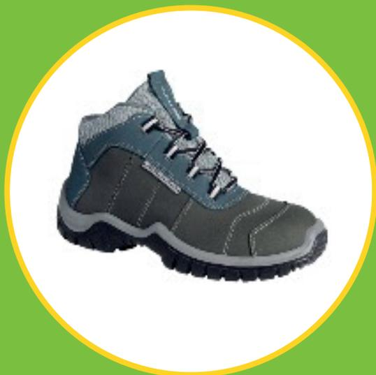
**Calçado de segurança** tipo baixo, cabedal confeccionado em couro curtido ao cromo na cor grafite com azul, forro em não tecido, fechamento através de atacadores, palmilha de montagem em não tecido, palmilha interna, biqueira de PVC para conformação, solado de poliuretano bidensidade na cor preta, antiderrapante, resistente ao óleo combustível.
