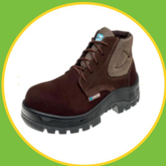
**Calçado de segurança** isolante elétrico tipo botina confeccionada em vaqueta, com biqueira de composite, sem componentes metálicos, fechamento com atacadores para amarrar, dorso acolchoado em espuma, com palmilha de montagem em aramida antiperfurante fixada pelo sistema strobrel, palmilha interna removível, solado em poliuretano antiderrapante bidensidade injetado diretamente ao cabedal e sistema de absorção de impacto na região do calcanhar ou barra anti-torção, para uso eletricista.
