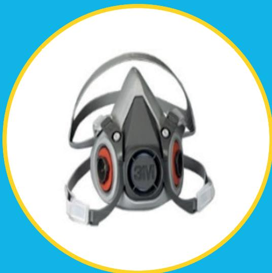
**Máscara de segurança** com filtro químico, respirador purificador de ar, tipo peça semifacial, com corpo moldado em material plástico rígido e em elastômero sintético (borracha ou silicone), com tirantes ajustáveis, válvulas de inalação/exalação e suporte para acoplar filtros químicos substituíveis, combinado ou não com retentor de filtros mecânicos para uso simultâneo com os filtros químicos.
