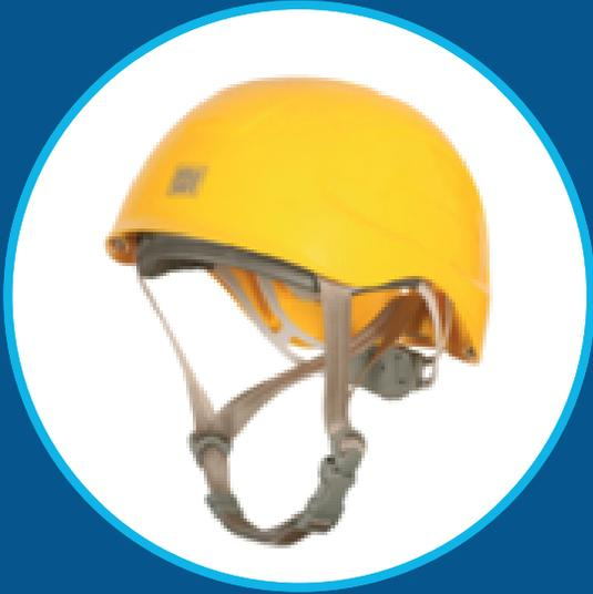
**Capace de segurança** classe B - Tipo III, com casco em Polietileno de alta densidade. Suspensão composta por carneira plástica. Coroa de poliamida e espuma de conforto removível. Placas de ancoragem e pinos de ancoragem (macho e fêmea). Mecanismo de regulagem diametral através de catraca giratória. Jugular de quatro pontos ajustável. Fendas laterais para encaixe de acessórios.
